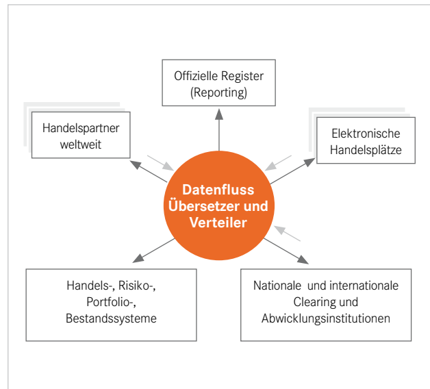
Abbildung 2: An der Kommunikation beteiligte interne und externe Systemkomponenten am Beispiel einer Hub-and-Spoke-Technologie
